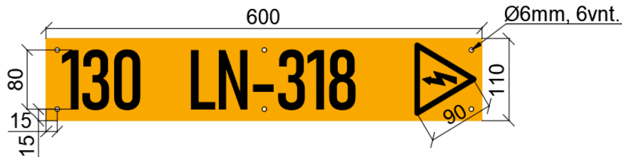
1.3.4. Lentelės prie metalinių atramų tvirtinamos per tris taškus.
